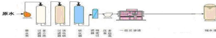
原水→原水泵→活性炭过滤器→离子交换树脂→阻垢系统→保安过滤器→多级高压泵→一级反渗透→储水罐
